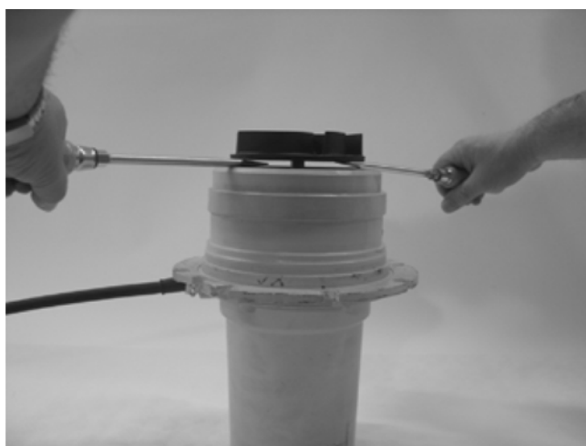
Рис. 28: Снятие рабочего колеса
