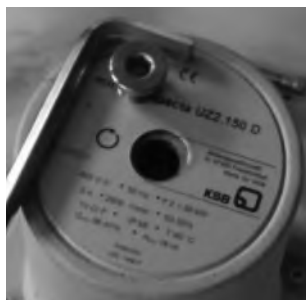
Рис. 13: Направление вращения насоса
